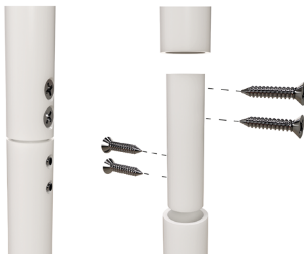
Bildet viser skjøting av 20 og 25 mm rør ved rørskifte.
