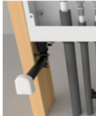
Dreneringsbend koblet direkte mot skapets utløpsstuss munner i samme rom som skapets serviceåpning, alterna- tivt i rommet bak.
