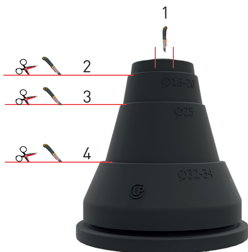
Kapping av rørgjennomføring.
