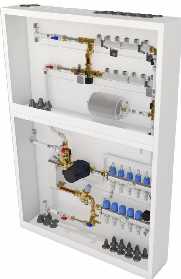
LK Kombiskap UNI-X er en komplett enhet for distribusjon av gulvvarme/radiatorvarme, kaldtvann og varmtvann i en bolig.
