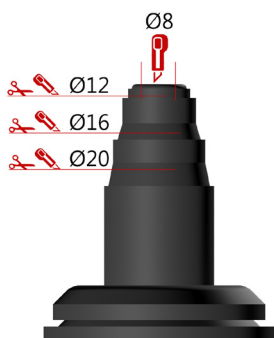
Kapping av rørgjennomføring.
