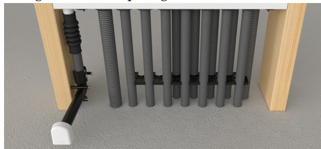
Prinsippskisse. Dreneringsbend tilkoblet via varerør.
