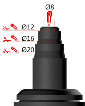
Kapping av rørgjennomføring
