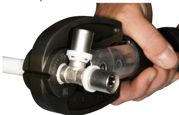
En åpning i forkant av bakkene kan skyldes at et fremmedlegeme har havnet mellom bakkene og hindret sammenpressingen.
