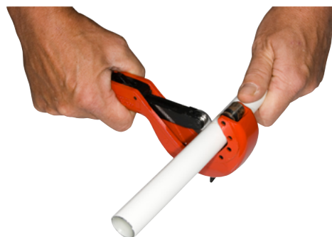
Kapping med rørkutter utstyrt med skjæreskive for plastrør eller rørsaks.
