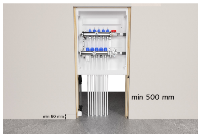
Eksempelbilde på montering av skapet med en avstand på 500 mm fra gulvflaten.
