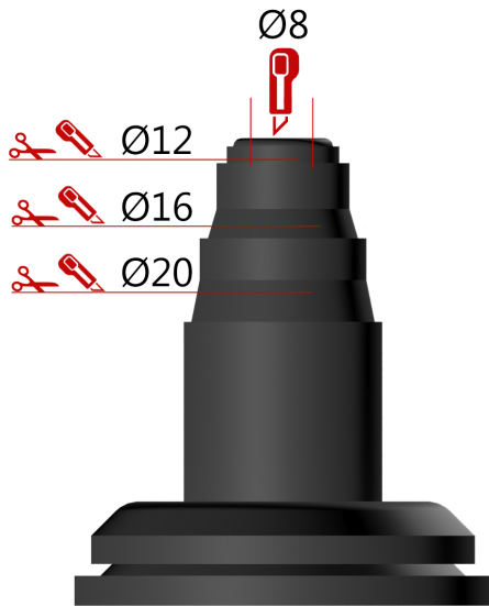
Kapping av rørgjennomføring for gulvvarmerør.
