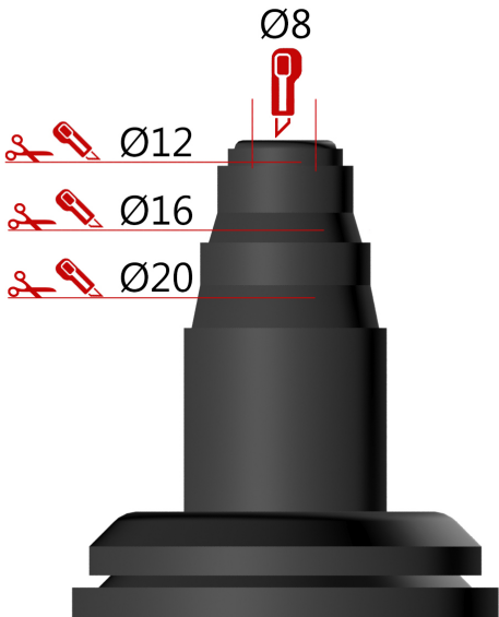
Kapping av rørgjennomføring.
