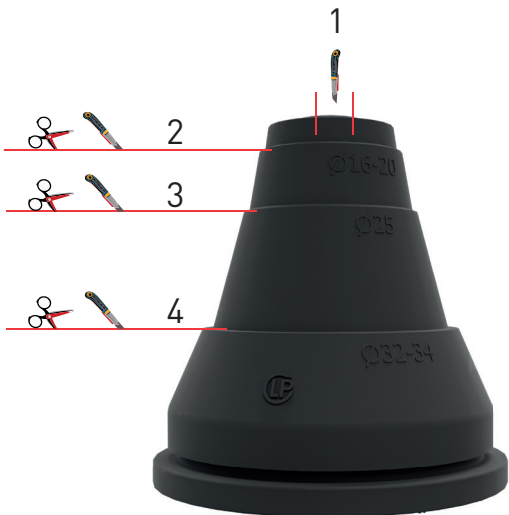
Kapping av rørgjennomføring.
