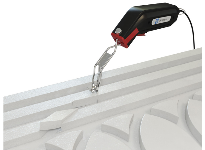
Sporing i EPS-celleplastskive med LK Varmekniv 90 W.
