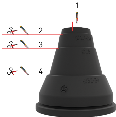
Kapping av LK Rørgjennomføringer 20-25 LP .
