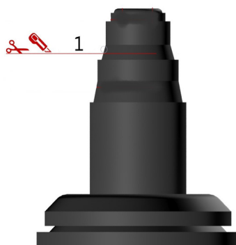
Kapping av LK skapgjennomføring 16mm.
