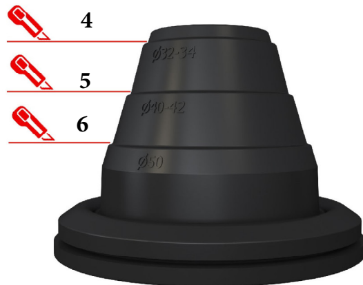
Kapping av skapgjennomføringer 32-50mm benyttes til spesialbestilte sjaktbunner.
